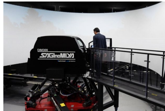
左：Calabogie Motorsports Parkでの自動運転走行をDiM300上でデモンストレーション 右：モーションプラットフォームに搭載されたコックピットの運転席に乗り込む
